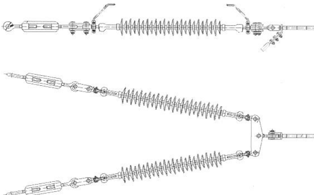
Figura 19 Lanț dublu de întindere în “V” cu izolatoare compozite Hi*Lite XL – tip tijă, pentru tensiunea de 110 kV
